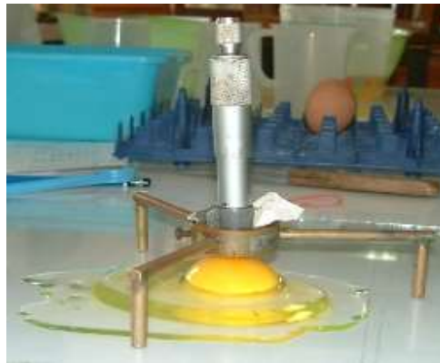
Penentuan tinggi albumen dengan mikrometer
