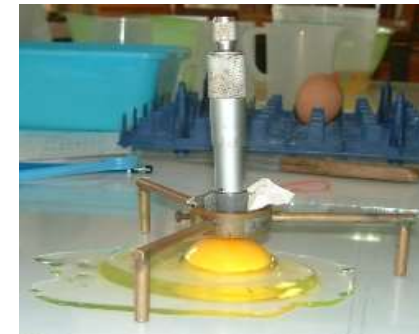
Mengukur tinggi Yolk dengan Mikrometer
